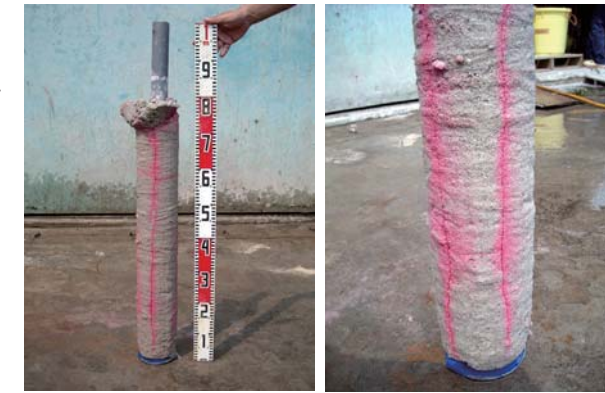
ポリゴンパイプ クラッキング試験 (クラック発生状況)
